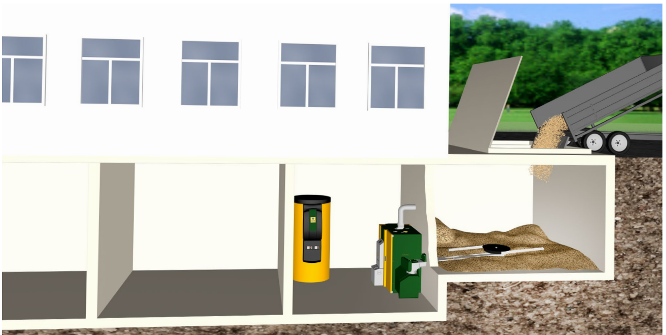
KWB Multifire med omrører og transportsnegl: direkte lager opfyldning
