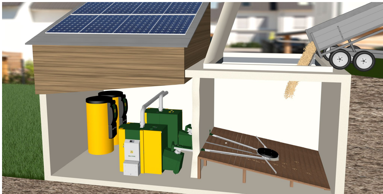
KWB Multifire dobbelanlæg med omrører og 2 transportsnegle: direkte lager opfyldning
