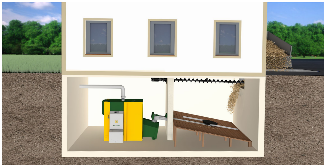
KWB Multifire med omrører og transportsnegl: Lager opfyldning med transportsnegl
